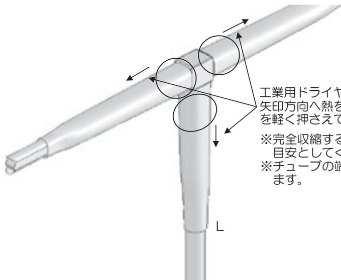
工業用ドライヤー又はガストーチでT分岐側から矢印方向へ熱を加え完全収縮させ熱いうちにL部を軽く押さえて完成です。
